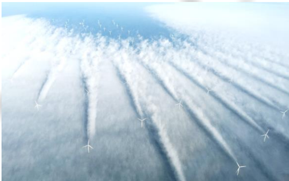
Visualisierung aerodynamischer Nachlaufeffekte von WKA in Form von Winddefizitkanälen und Randturbulenzen, Quelle: BWLW
